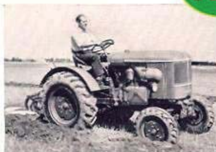
Tiefpflügen von Leimboden mit Zweifur-Arbeitspflug, Arbeitstiefe 28 cm, Arbeitsbreite 60 cm.
