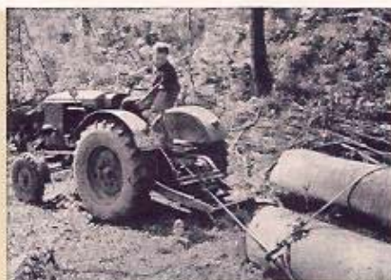
Mit der kräftigen Seilwinde von 3500 kg Zugkraft werden schwere Stämme mühelos abgeschleppt.
