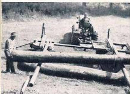
Beladen des Langholzwagens; die Baumstämme werden spielend mit dem Seil heraufgerollt.
