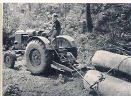
Mit der kräftigen Seilwinde von 3500 kg Zugkraft werden schwere Stämme mühelos abgeschleppt.
